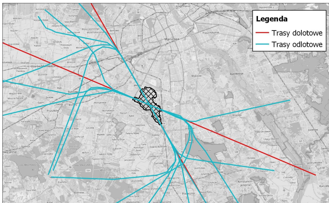
Rysunek 140 Główne trasy operacji lotniczych wg stanu na rok 2021 ujęte w SMH 2022 dla lotnisk [źródło: opracowanie własne na podstawie SMH Lotniska Chopina 2022]
